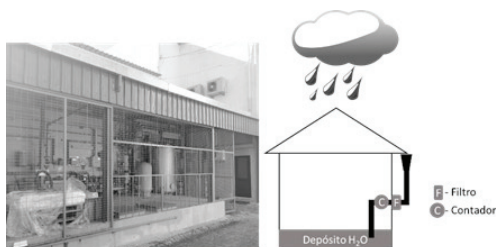
Figura 4: Recuperação de águas pluviais da cobertura do edifício – ETA
