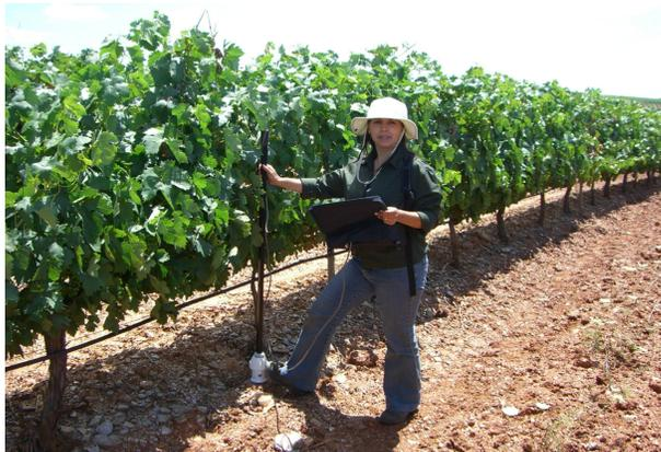
Fig. 20 Monitorização da água do solo com sonda “Diviner”
