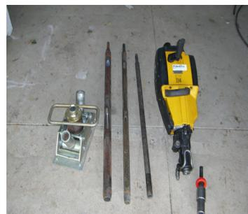
Fig. 8- Aspecto do equipamento para recolha de amostras de solo.
