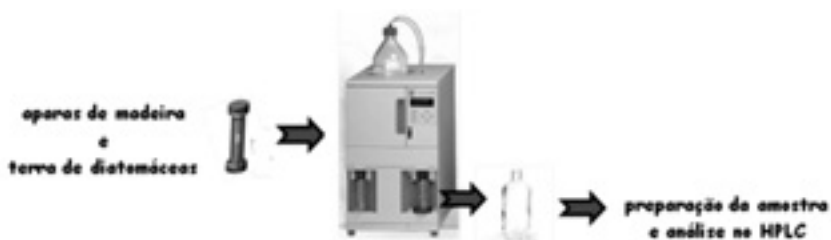
Figura 1- Representação esquemática da extracção dos compostos fenólicos de aparas de madeira utilizando um extractor com líquido pressurizado.
